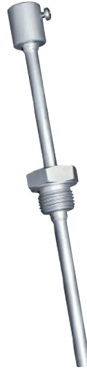
TH08-VA/xx/90 Manguito de inmersión con tubo de cuello, de acero inoxidable V4A, sellado plano, cilíndrico, según DIN 228
